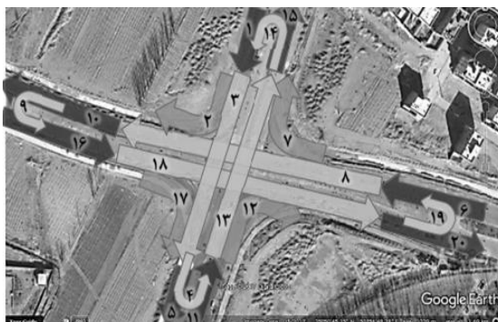
شکل ۳- اصلاحات پیشنهادی به صورت تقاطع هم سطح چراغدار در وضعیت موجود تقاطع ۳
